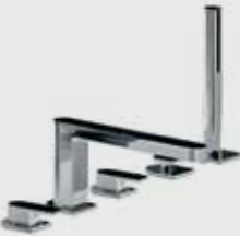
6365U 5-Hole Roman tub set, 8 1/4" spout projection / Ceramic cartridges. Mélangeur bain-douche sur gorge, entraxe bec 8 1/4" / Têtes céramiques. Grupo bañera repisa, distancia a chorro 8 1/4" / Cartuchos de disco cerámico.
